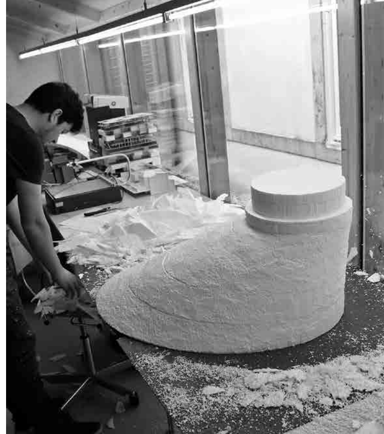
Ejecución de ARX de molde para los encofrados de concreto armado (óculo en el piso 1). Fotografía: ARX.
